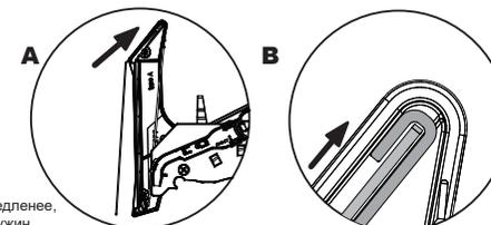
\*Если после установки постеров флапы стали закрываться быстрее/медленнее, необходимо произвести настройку пружин. Для настройки пружин см. стр.10
