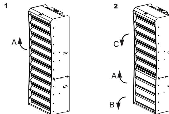
1. При открытии за одну из верхних флапов, откроются только верхние флапы. (1-A)
