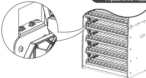
Используйте переключатели для вкл/выкл подсветки двух флапов нижнего модуля.
