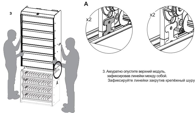
3. Аккуратно опустите верхний модуль, зафиксировав линейки между собой. Зафиксируйте линейки закрутив крепёжный шуруп.
