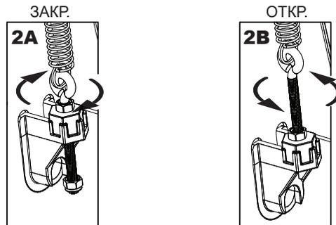
\*В случае шумного закрывания флапов, корректируйте тягу пружин(ы) в соответствии с желаемым результатом.
