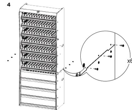
4. Зафиксируйте модули между собой, закрутив 3 винта М4х10 с каждой стороны.
