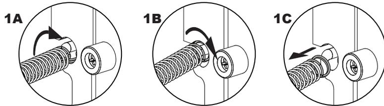
Для синхронной работы флапов необходимо произвести настройку! Настройка выполняется посредством усилением/ослаблением тяги пружины.
